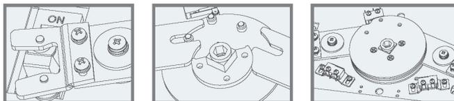
推动手柄采用可调式滑块结构设计, 适应的断路器合分行程更广, 让生产过程中的各道工序更加简便。
